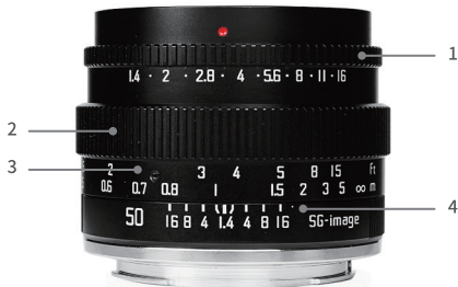
1.光圈环 2.对焦环 3.对焦刻度 4.景深标尺
